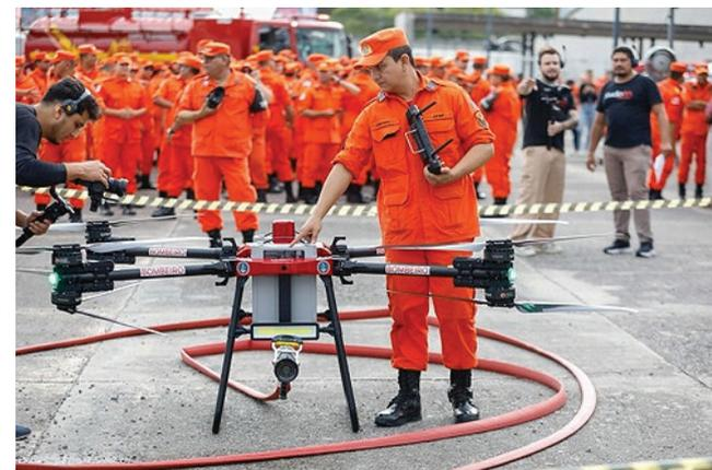
metros até o foco do fogo, o equipamento suporta até 90 quilos de carga e tem autonomia de voo de 30 minutos. A água é fornecida diretamente pela viatura, assegurando suprimento contínuo durante a operação.
